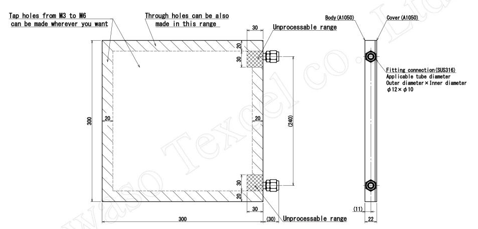
「Unit: Millimeter」 Weight: about 4.9kg
